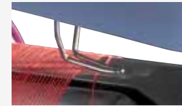
Opto-mechanical sensor for yarn reserve (always maximum) Sensore opto-meccanico di riserva filo (sempre al max)
