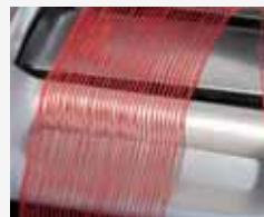
Windings separation, adjustable from 0 to 2.4 mm Separazione spire regolabile da 0 a 2.4mm
